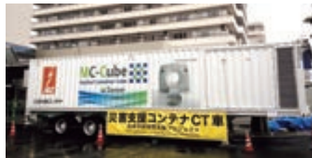
コンテナ型ディーゼル発電機付CT*車
